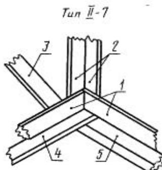
1 — горизонтальные детали торцового и бокового шитов; 2 — стойки; 3 — раскос; 4 — доски пола; 5 — поперечные ползья
