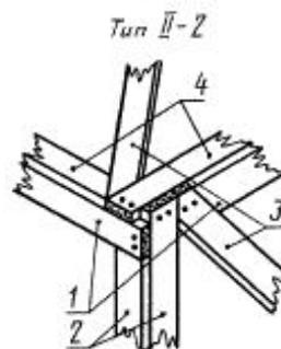
1 — горизонтальные детали торцового и бокового шитов; 2 — стойки; 3 — раскос; 4 — деталь крышки
